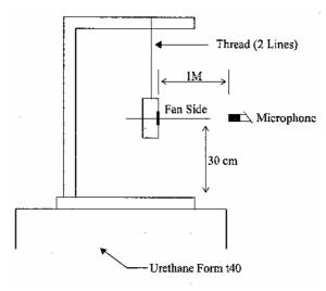
1 METER FROM MICROPHONE TO FAN INTAKE
