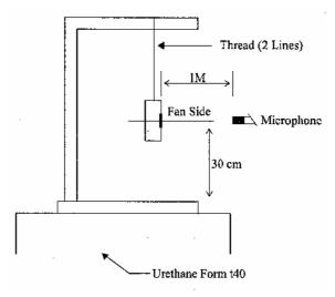
1 METER FROM MICROPHONE TO FAN INTAKE
