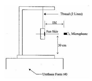
1 METER FROM MICROPHONE TO FAN INTAKE
