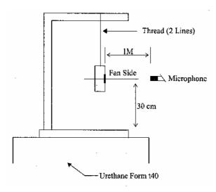
1 METER FROM MICROPHONE TO FAN INTAKE
