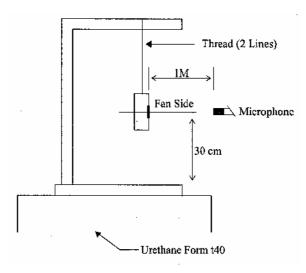
1 METER FROM MICROPHONE TO FAN INTAKE
