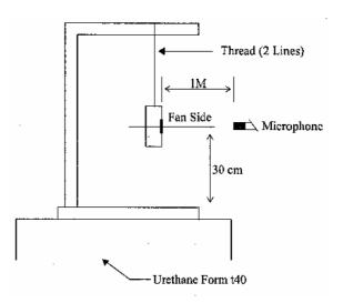
1 METER FROM MICROPHONE TO FAN INTAKE
