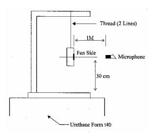
1 METER FROM MICROPHONE TO FAN INTAKE
