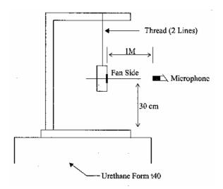
1 METER FROM MICROPHONE TO FAN INTAKE
