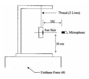
1 METER FROM MICROPHONE TO FAN INTAKE
