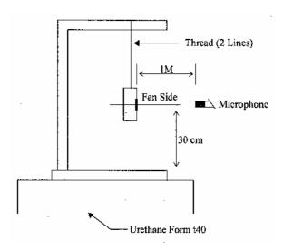
1 METER FROM MICROPHONE TO FAN INTAKE
