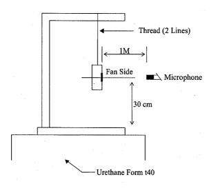
1 METER FROM MICROPHONE TO FAN INTAKE
