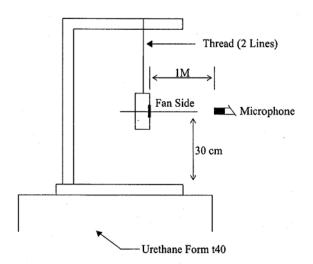
1 METER FROM MICROPHONE TO FAN INTAKE
