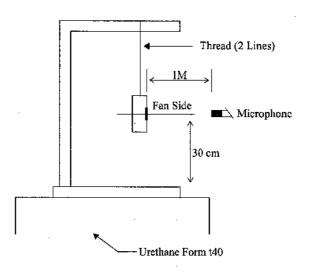
1 METER FROM MICROPHONE TO FAN INTAKE
