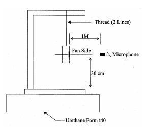
1 METER FROM MICROPHONE TO FAN INTAKE
