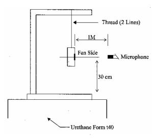
1 METER FROM MICROPHONE TO FAN INTAKE
