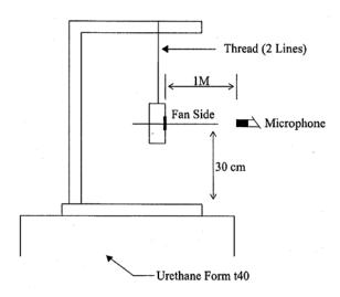
1 METER FROM MICROPHONE TO FAN INTAKE
