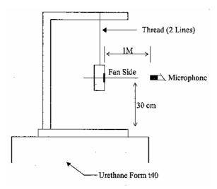
1 METER FROM MICROPHONE TO FAN INTAKE
