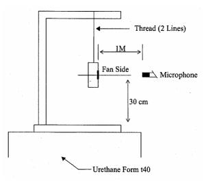
1 METER FROM MICROPHONE TO FAN INTAKE
