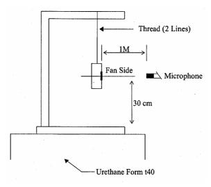
1 METER FROM MICROPHONE TO FAN INTAKE
