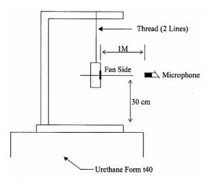
1 METER FROM MICROPHONE TO FAN INTAKE
