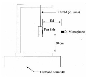
1 METER FROM MICROPHONE TO FAN INTAKE
