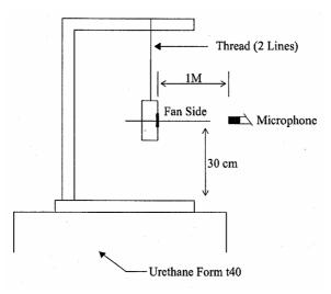
1 METER FROM MICROPHONE TO FAN INTAKE
