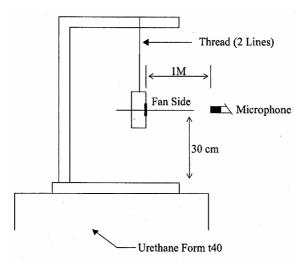
1 METER FROM MICROPHONE TO FAN INTAKE
