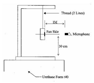
1 METER FROM MICROPHONE TO FAN INTAKE
