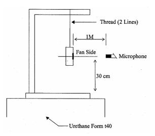
1 METER FROM MICROPHONE TO FAN INTAKE
