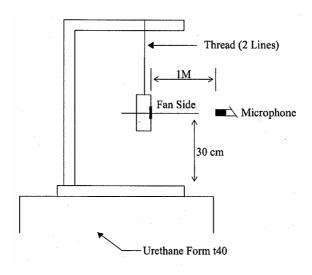
1 METER FROM MICROPHONE TO FAN INTAKE
