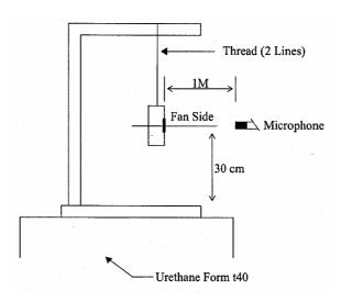
1 METER FROM MICROPHONE TO FAN INTAKE
