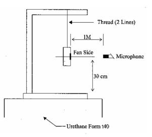
1 METER FROM MICROPHONE TO FAN INTAKE
