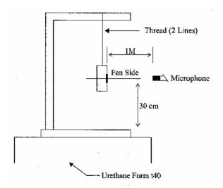
1 METER FROM MICROPHONE TO FAN INTAKE
