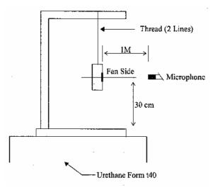
1 METER FROM MICROPHONE TO FAN INTAKE
