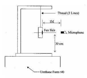
1 METER FROM MICROPHONE TO FAN INTAKE
