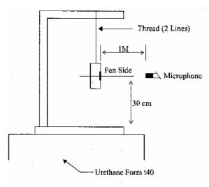
1 METER FROM MICROPHONE TO FAN INTAKE
