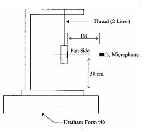
1 METER FROM MICROPHONE TO FAN INTAKE
