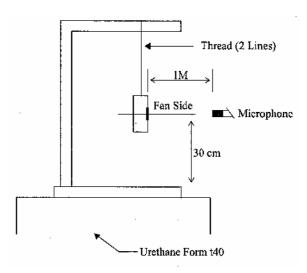
1 METER FROM MICROPHONE TO FAN INTAKE
