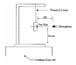
1 METER FROM MICROPHONE TO FAN INTAKE
