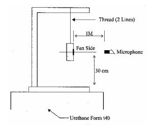
1 METER FROM MICROPHONE TO FAN INTAKE
