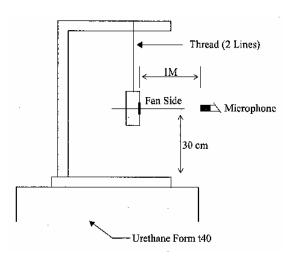
1 METER FROM MICROPHONE TO FAN INTAKE
