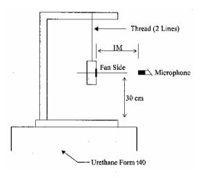
1 METER FROM MICROPHONE TO FAN INTAKE
