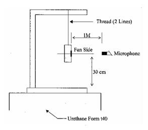
1 METER FROM MICROPHONE TO FAN INTAKE
