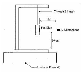
1 METER FROM MICROPHONE TO FAN INTAKE
