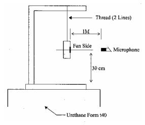
1 METER FROM MICROPHONE TO FAN INTAKE
