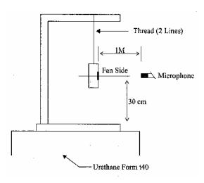
1 METER FROM MICROPHONE TO FAN INTAKE
