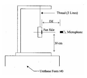
1 METER FROM MICROPHONE TO FAN INTAKE
