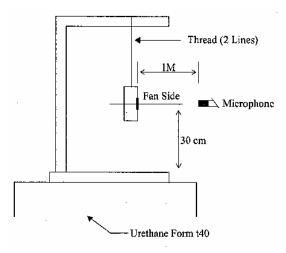
1 METER FROM MICROPHONE TO FAN INTAKE
