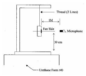
1 METER FROM MICROPHONE TO FAN INTAKE
