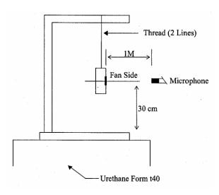
1 METER FROM MICROPHONE TO FAN INTAKE
