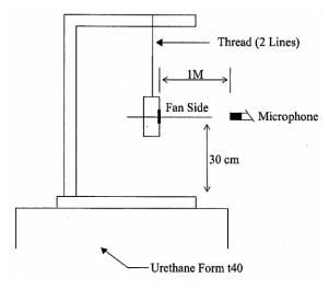
1 METER FROM MICROPHONE TO FAN INTAKE
