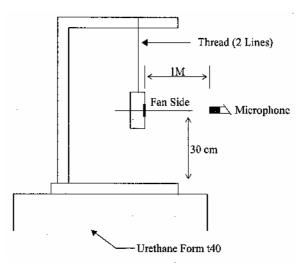
1 METER FROM MICROPHONE TO FAN INTAKE
