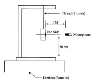
1 METER FROM MICROPHONE TO FAN INTAKE
