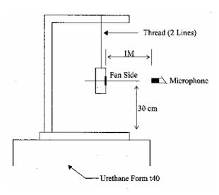
1 METER FROM MICROPHONE TO FAN INTAKE
